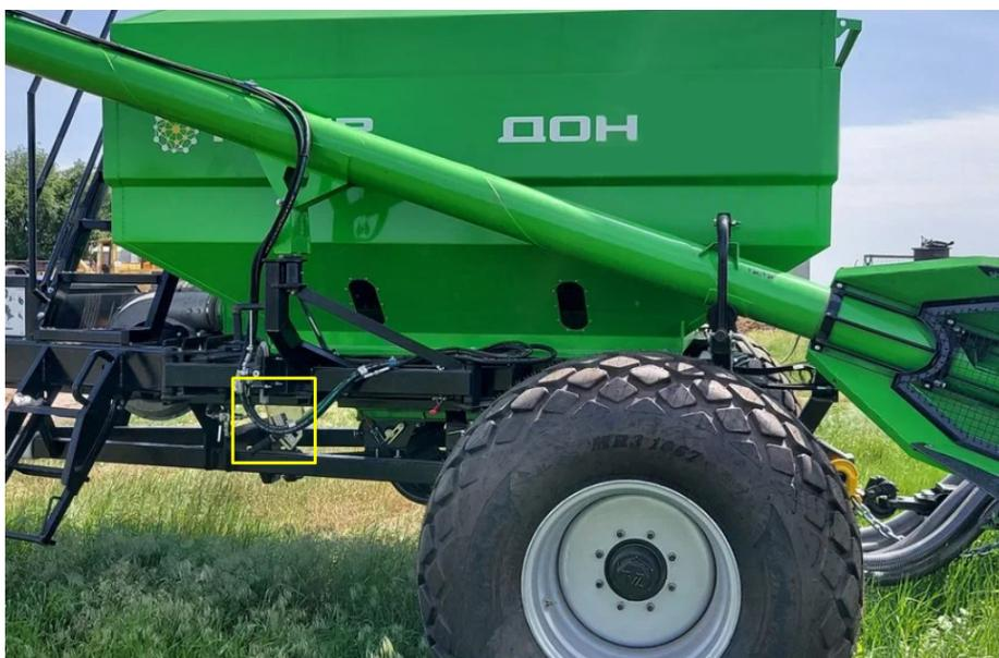
Рисунок 19 – Расположение рычага заслонки
