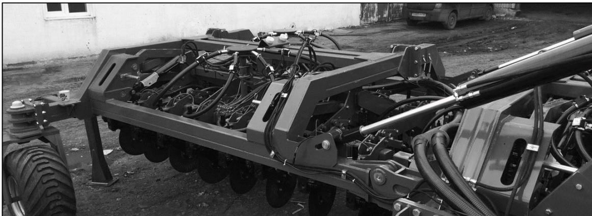
Рисунок 50 – Гидроцилиндры складывания боковых секций
