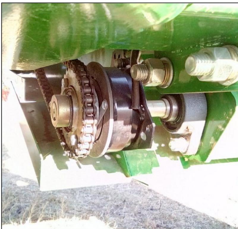
Рисунок 54 – Электромагнитная муфта привода
