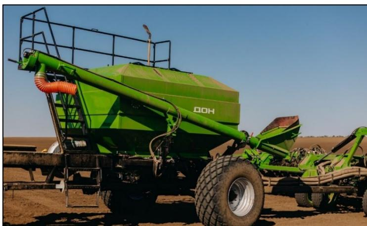
Рисунок 3 – Шнек в транспортном положении
